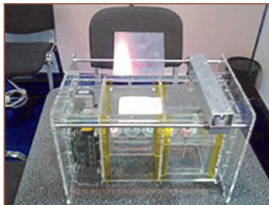
Модель розробленого 3D-принтера
