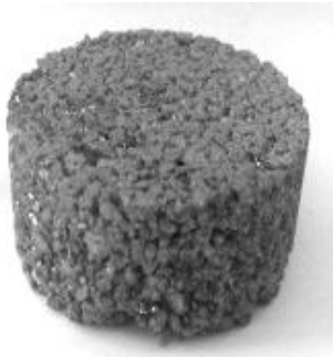
Рис. 1. Пористий фільтр з \text{SiO}_2
