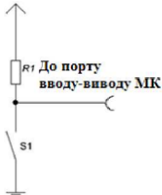
Рисунок 3.6. – Схема підключення кнопки
