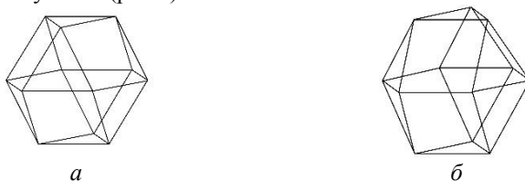
Рис. 1. ГЦК та ГЦР решітки для пакування рівних сфер: a – Кубооктаедричне ГЦК пакування, б – Оберненокубооктаедричне ГЦР пакування
