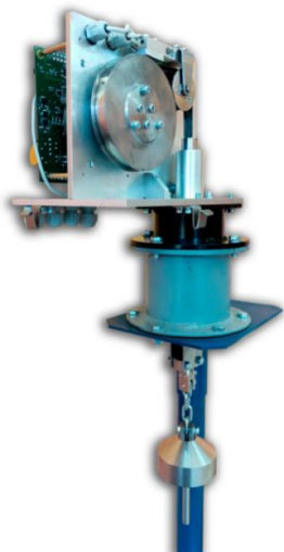
Рисунок 1 – Вимірювач рівня на налагоджувальному стенді, без захисного кожуха
