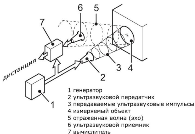
Рис. 2. Принцип роботи ультразвукового дальноміра
