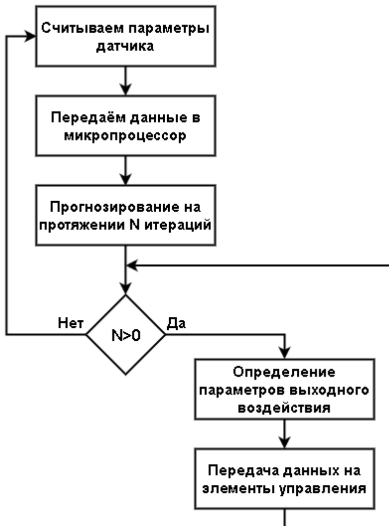
Рис. 3. Алгоритм прогнозирования направления движения
