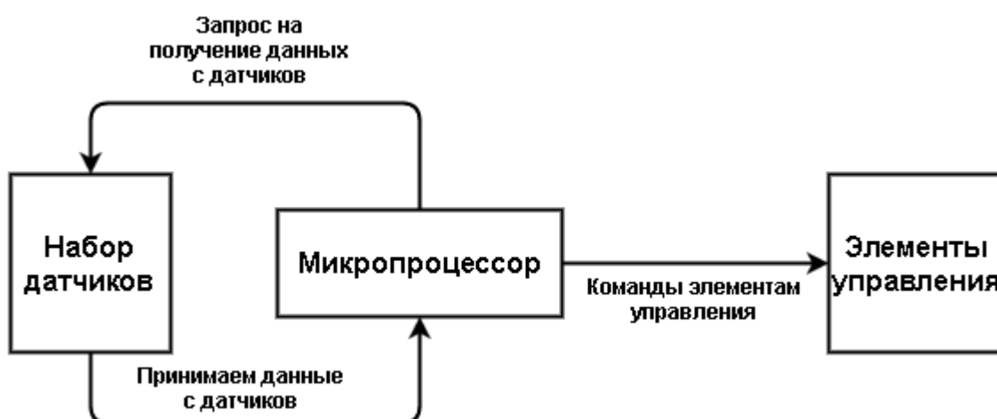
Рис. 4. Структурная схема компьютерной системы управления стабилизацией мобильной платформой
