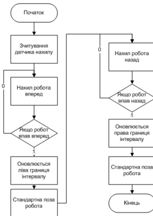
Рис. 4. Блок-схема підпрограми «Визначення інтервалу рівноваги»
