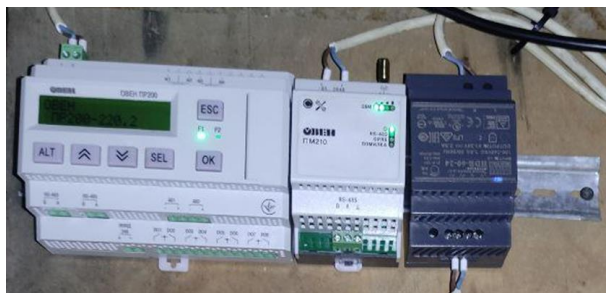
Рис. 1. ОВЕН ПР-200 (зліва), ОВЕН ПМ-210 (в центрі) та джерело живлення 24В (справа) на випробувальному стенді
