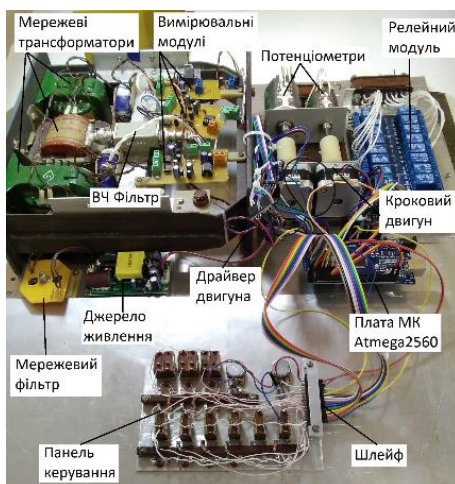
Рисунок 2 – Блоки вимірювання напруги, струму й температури
