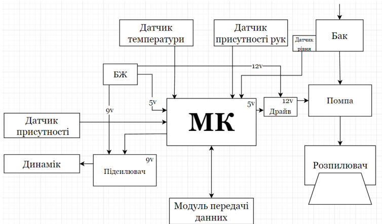
Рисунок 1 – Функціональна схема автоматичного дезінфектора для рук
