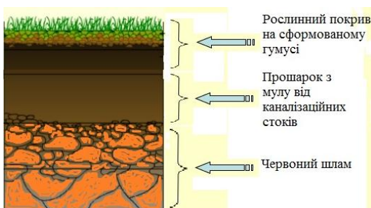
Рисунок 1 – Схема формування захисного бар'єру на агресивній поверхні техногенного масиву
