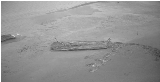
Рис. 3.5.2.2. Очеретяний мат покрито шламовими змивами з дамби
