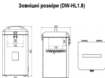
Рисунок 5.3 – Переносна морозильна камера моделі DW-HL1,8 [70]
