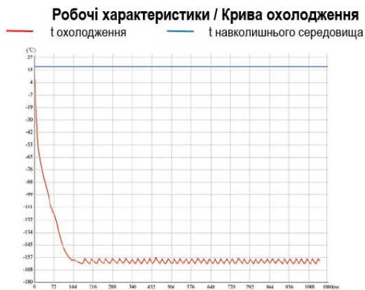
Рисунок 5.5 – Кріо-морозильна камера моделі DW-ZW128 [70]
