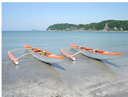
Рис. 6.6. Типове сучасне полінезійське каное з аутригером [80]
