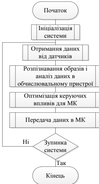
Рис. 2. Блок-схема алгоритму функціонування інтелектуалізованої автоматичної системи керування Інтернет-речами
