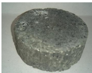
Рис. 3. Композит з закритою пористістю Al 2 O 3 корунд + Рідке скло
