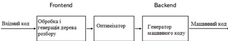
Рис. 1. Схема трьох етапної компіляції
