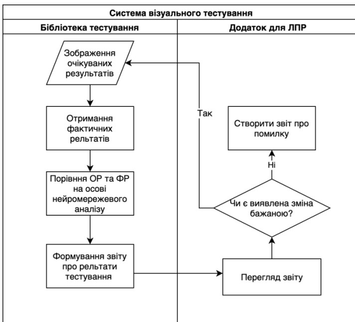
Рис. 2. Схема роботи автоматизованої системи візуального тестування
