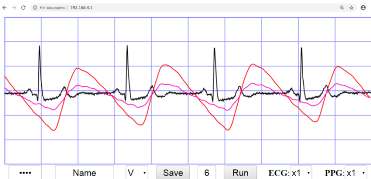
Рис.2. Приклад HTML-інтерфейсу WiFi-ECG-PPG пристрою
