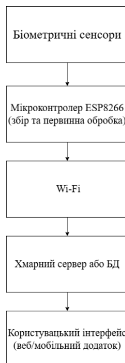
Рис. 1. Узагальнена архітектура IoT-системи моніторингу стресу
