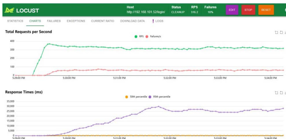
Рис. 1. Результати навантажувального тестування багаторівневої реалізації системи моніторингу в середовищі Locust
