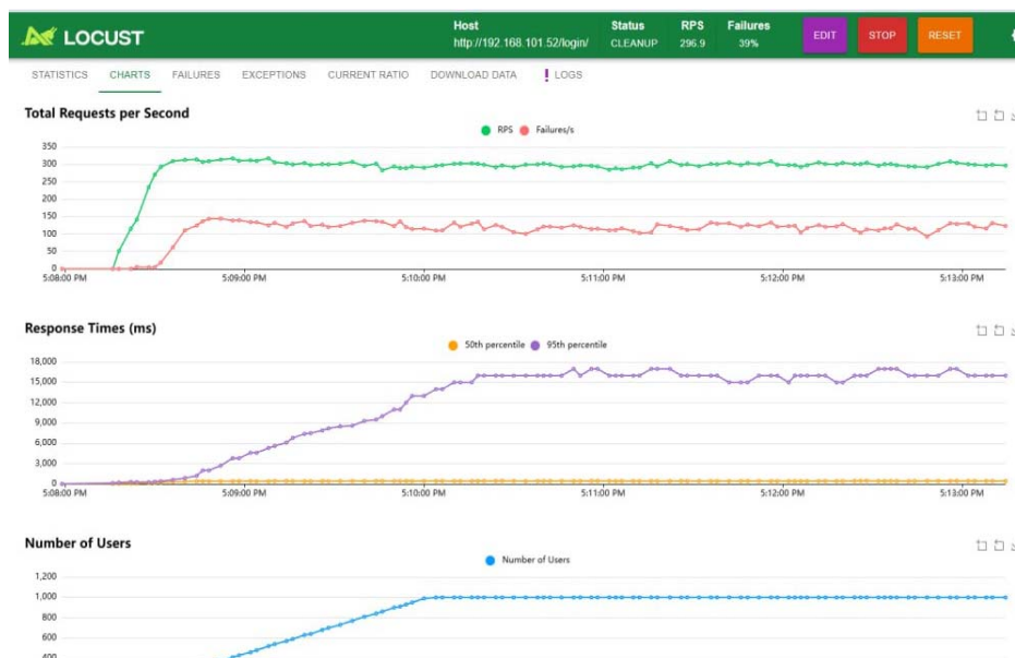
Рис. 2. Результати навантажувального тестування монолітної реалізації системи моніторингу в середовищі Locust
