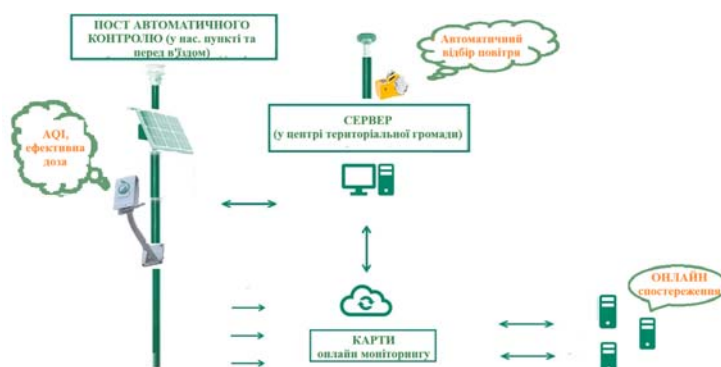
Рис. 1 Принципова схема Smart-системи еколого-радіаційного моніторингу атмосферного повітря у населеному пункті, через який проходить автомагістраль
