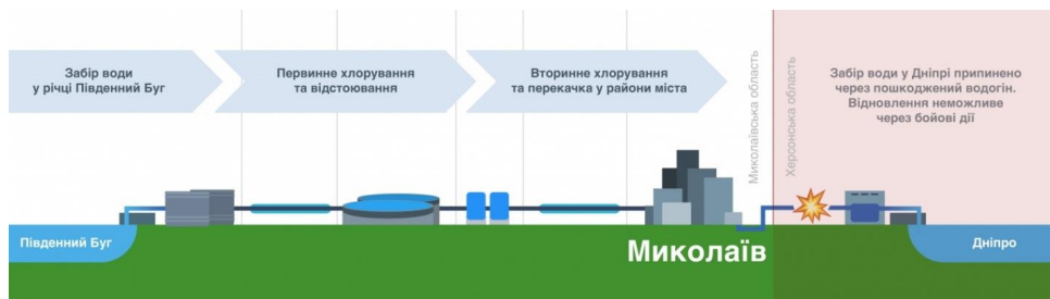
Рис. 1.24. Схема очищення води міста (з відкритих джерел).
