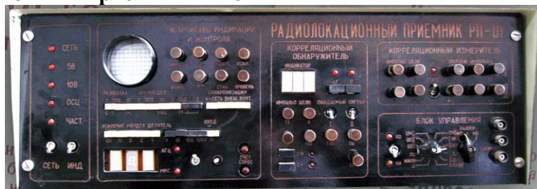
Рис. 1. Радиолокационный приемник РП-01
