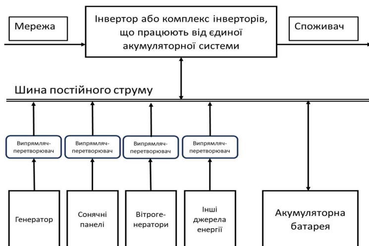
Рис. 2. Схема забезпечення безперебійного живлення споживачів електричною енергією із різних джерел
