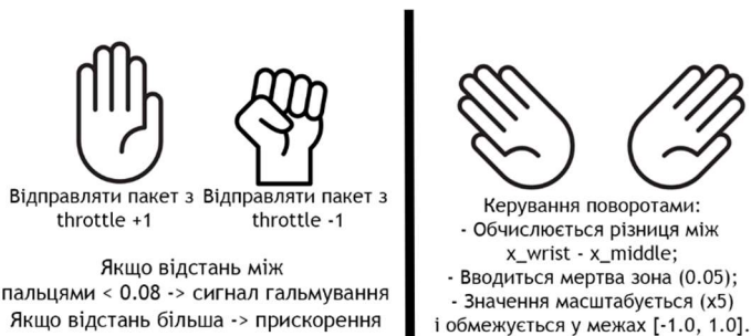
Рис. 1. Алгоритм передачі даних використовуючи жести долоні.
