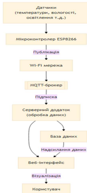
Рисунок 2 – Загальна схема IoT-системи на базі MQTT
