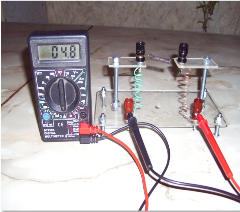
Рис. 5. Визначення залежності опору від температури матеріалу
