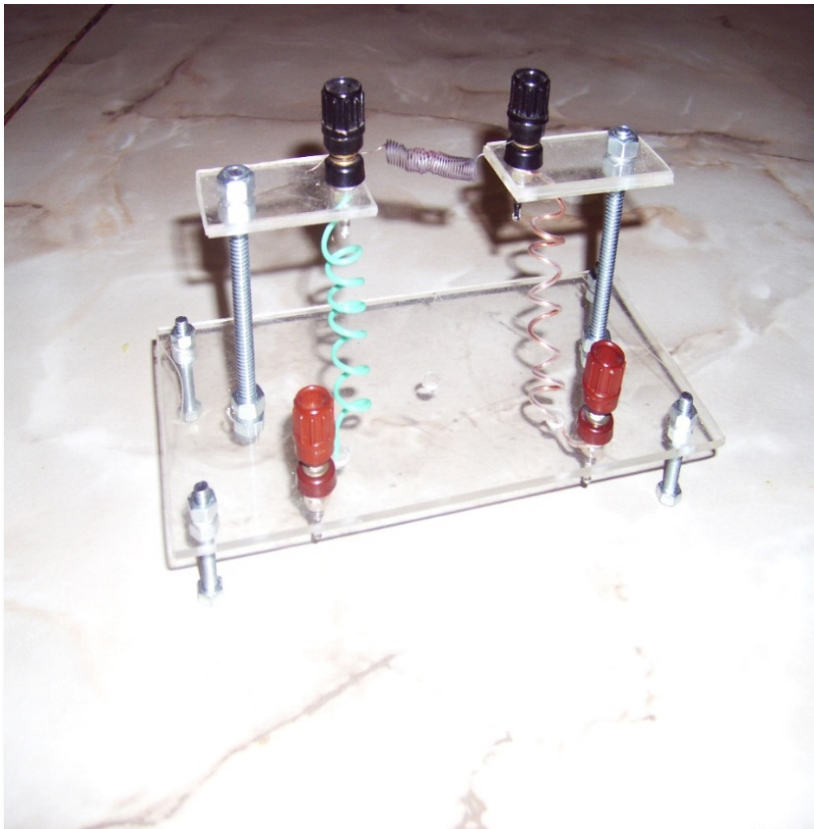
Рис. 4. Прилад для визначення матеріалу за провідністю
