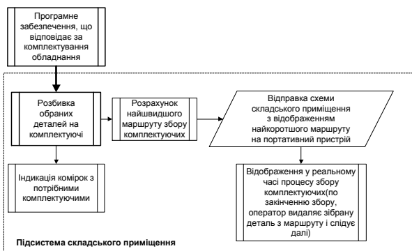
Рис.1. Схема функціонування підсистеми складського приміщення
