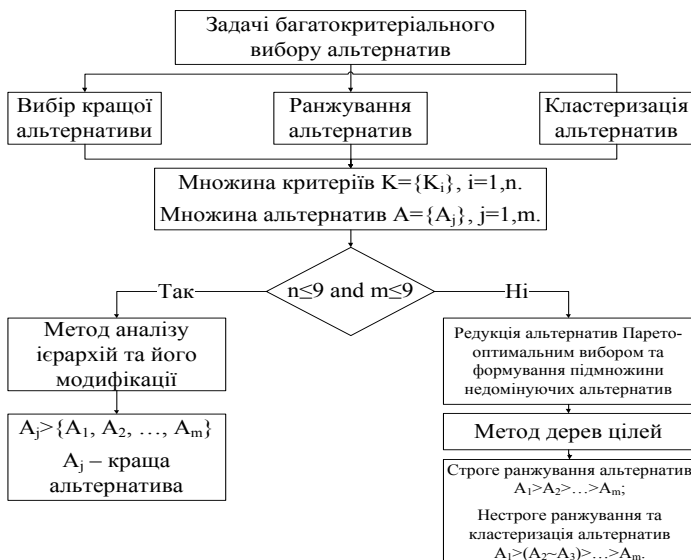
Рис. 1. Структура технології підтримки прийняття рішень у задачах вибору альтернатив на основі інтеграції МАІ, Парето-оптимального вибору та методу дерева цілей
