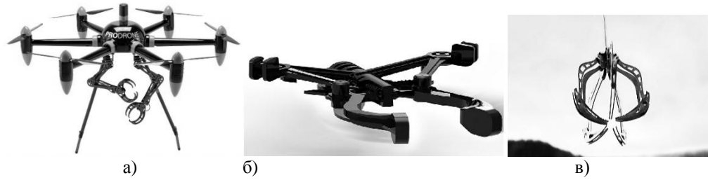
Рис. 7.16. Спеціалізовані захвати для дронів PRODRONE (а) [57], Parrot (б) [133], Mantis Drone Claw (в) [280]
