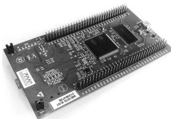
Рис. 4.13. Апаратні засоби для натурного моделювання стеганографічного рішення на основі плати STM32F429 Discovery
