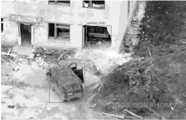
Рисунок 1 – Виявлення військових об'єктів на відео за допомогою моделі Faster R-CNN
