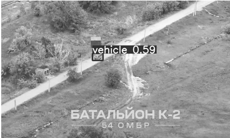
Рисунок 2 – Виявлення військових об’єктів на відео за допомогою моделі YOLOv11
