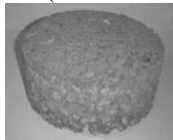
№1. \text{Al}_2\text{O}_3 +Титанова губка+рідке скло спечені в вакуумі
