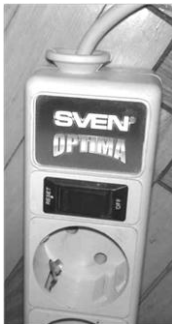
Рисунок Л9.3 – Подовжувач мережевий SVEN Optima без фільтра ВЧ-гармонік: а – зовнішній вигляд подовжувача; б – внутрішній монтаж фільтра з варистором CNR
