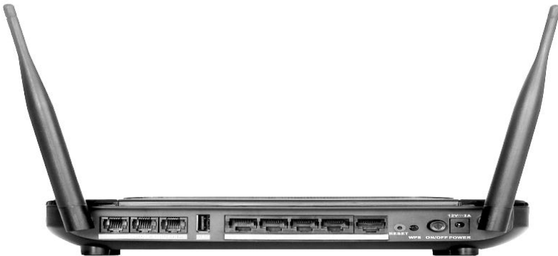
Рисунок 4.24 – Мультисервісний маршрутизатор D-Link DVG-N5402SP з голосовим шлюзом VoIP та Wi-Fi-N 300 Mbps, 1xWAN 10/100Base-T, 4xLAN 10/100Base-T, 2xFXS, 1xPSTN (LifeLine), 1xUSB, QoS
