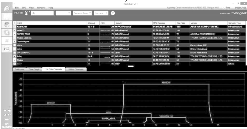
Рисунок Л8.2 – Перенастроєння власної мережі на 13-й Wi-Fi-канал у веб-інтерфейсі роутера (а) та відображення в інтерфейсі inSSIDer (б)
