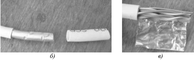
Рисунок 6.18 – Зняття стріпером зовнішньої ізоляції (а, б) та фольги (в) з кабелю «вита пара»
