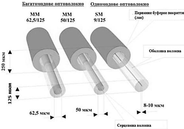
Рисунок 4.1 – Товщина оптоволокна (серцевини та оболонки)
