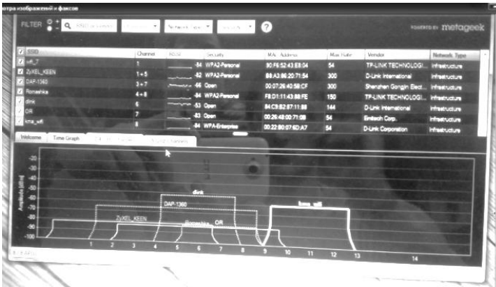
Рисунок 9.4 – Розподіл Wi-Fi-мереж між частотними каналами
