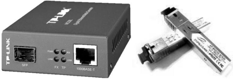
Рисунок 4.25 – Зовнішній (а) медіаконвертор MC220L TP-Link 1Gb x RJ-45 на 1Gb x SFP та вбудований (б) Модуль SFP WDM 1310nm SC (до 20 км на 1,25 Gbps)
