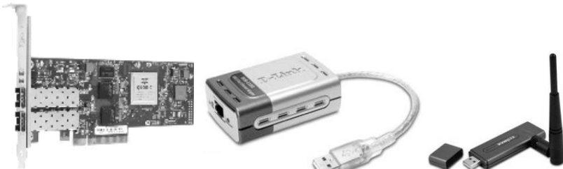
Рисунок 4.26 – Мережеві адаптери: внутрішній (а, PCI) Qlogic QLE8240-SR-CK 10Gb Single Port FCoE & iSCSI CNA, x8 PCIe, LC multi-mode optic та зовнішні (б, USB-Ethernet) D-Link DUB-E100 й (в, USB-Wi-Fi) EW-7318USG Edimax
