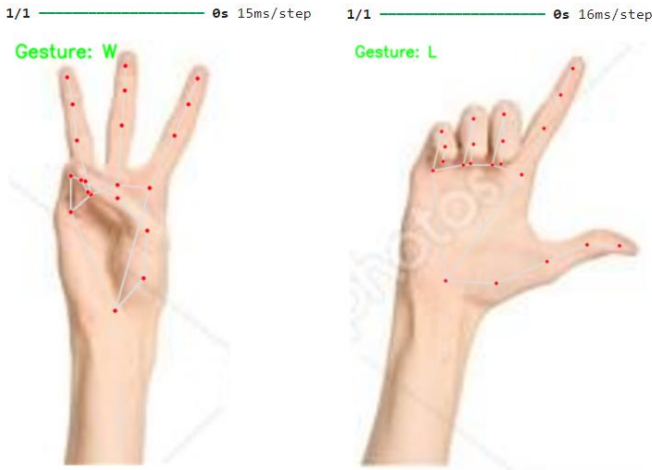
Рис.1. Процес розпізнавання жестової мови засобами MediaPipe
