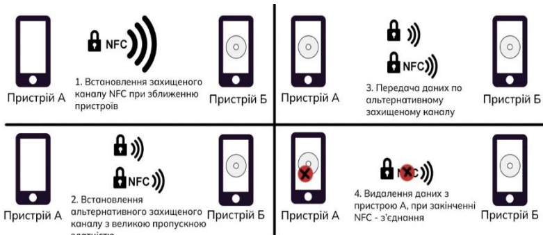
Рис.1. Схема реплікації з застосуванням NFC для встановлення захищеного каналу
