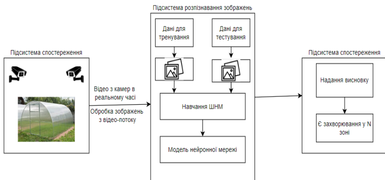
Рис.2. Структурна схему пропонованої розподіленої системи health-моніторингу теплиці
