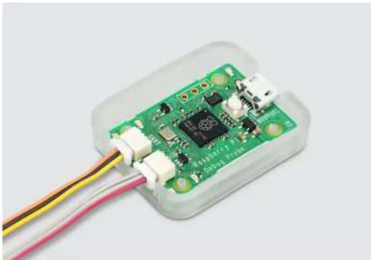
Рис.2. Програматор Raspberry Pi Debug Probe
