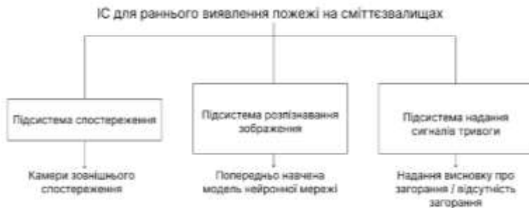
Рис. 1. Декомпозиція ІС для раннього виявлення пожеж на сміттєзвалищах
