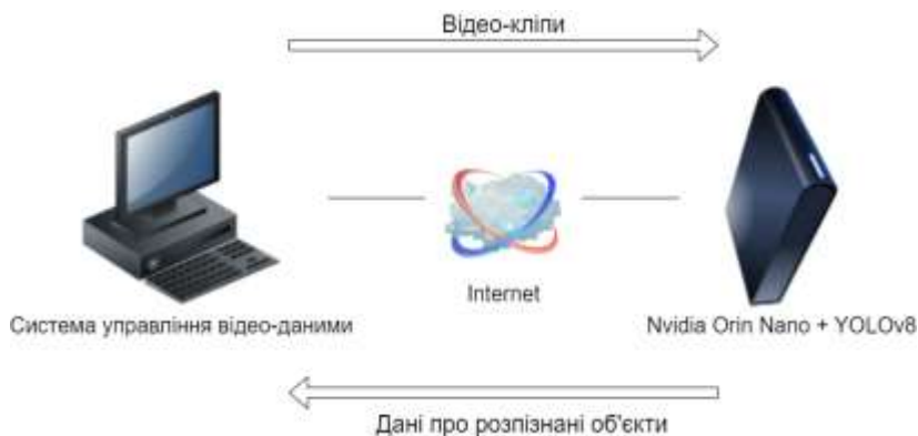
Рис.2. Декомпозиція системи обробки похибок сигналів тривоги отриманих відеозображень нейронною мережею
