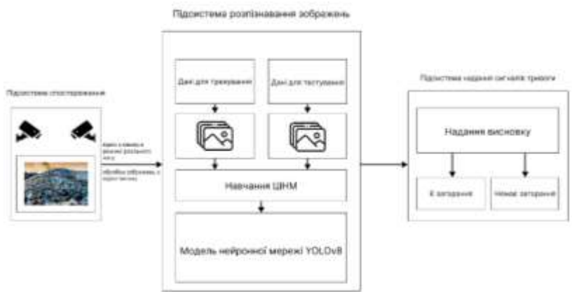
Рис. 2. Структурна схема пропонованої ІС для раннього виявлення пожеж на сміттєзвалищах на основі комп'ютерного зору
