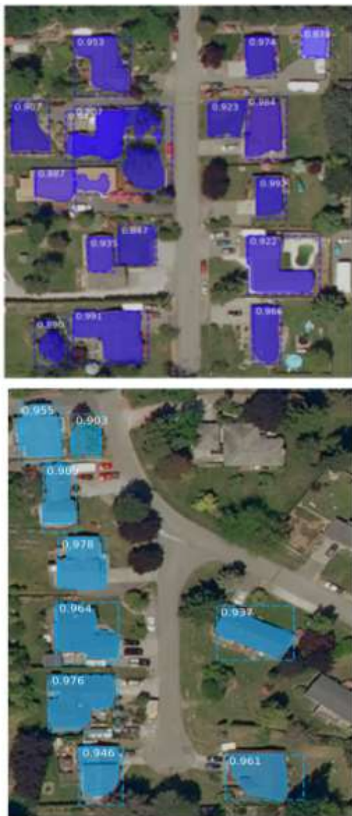
Рис.4. Результати роботи розробленого застосунку з контурування будівель
