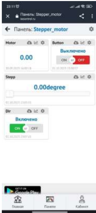
Рис.2. – Панель керування приводами
