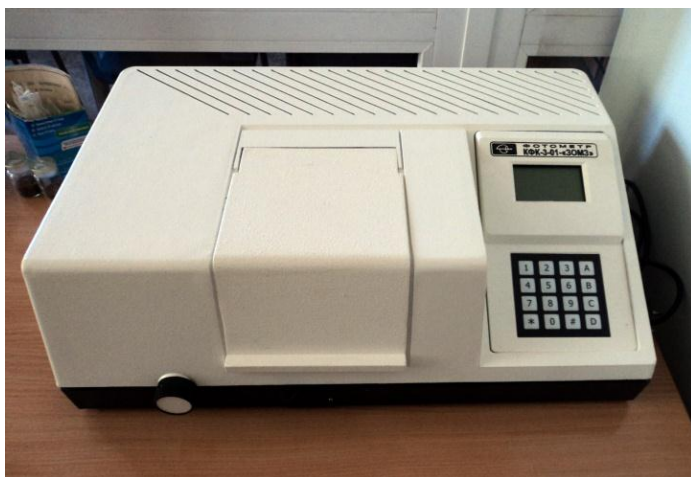
Рис. 2.12. Загальний вигляд фотоколориметра КФК-3-01-«ЗОМЗ»
