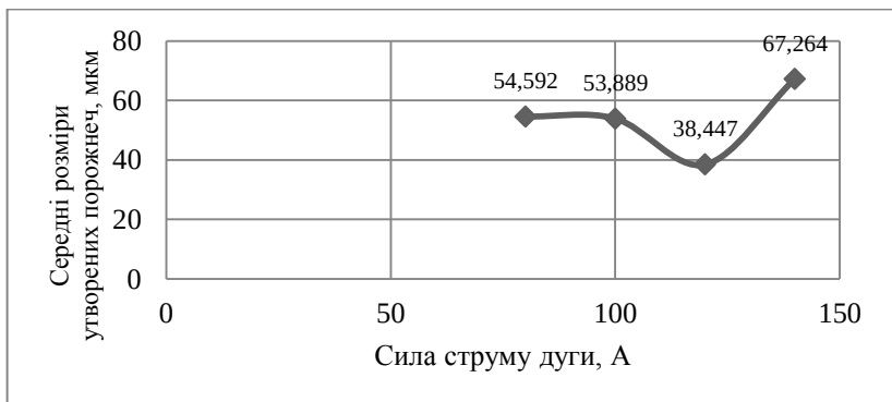
Рис. 2. Залежність середніх розмірів утворених порожнеч від сили струму дуги напильвання
