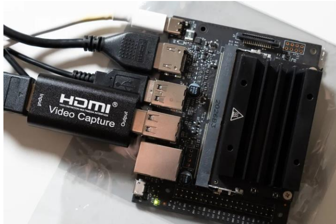
Рисунок 2 – Мікрокомп'ютер Jetson Nano з обчислювальною продуктивністю 472 GFLOPS
