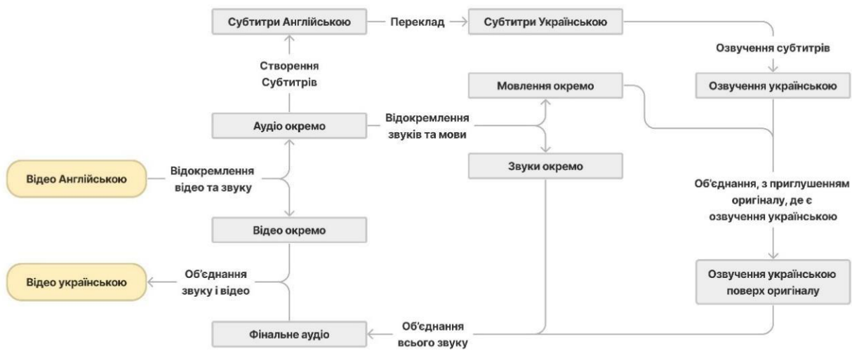
Рисунок 1 – Принцип роботи системи автоматичного перекладу відео.
