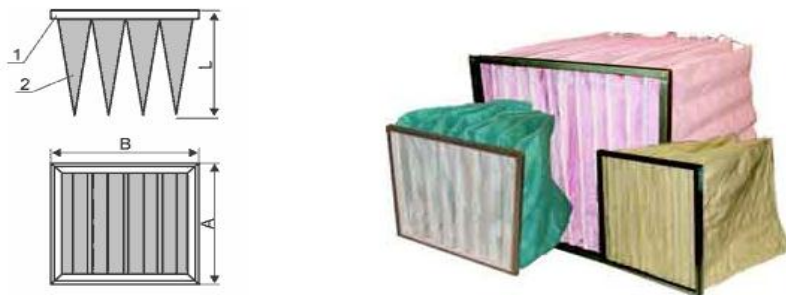
Рис. 3.16. Схема і вигляд фільтра ФяК
