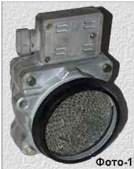
Рис. 7.6. Конструкція датчика масової витрати повітря (ДМВП):
