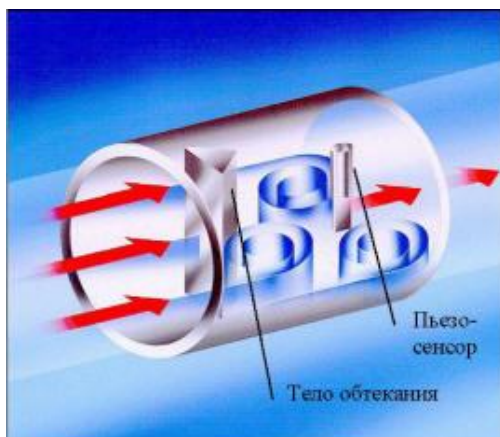
Рис. 7.10. Датчик витрати повітря виробництва MITSUBISHI, що працює за принципом підрахунку вихорів Кармана
