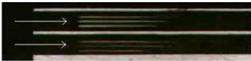
Рис. 7.17. Знос резистивного наплення
