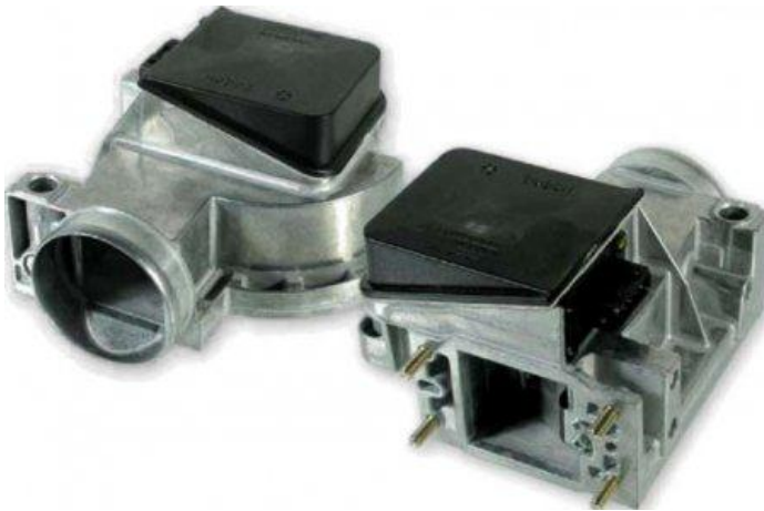
Рис. 7.11. Датчик об'ємної витрати повітря потенціометричного типу виробництва BOSCH
