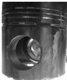
Фото 2. Повреждение поршня двигателя 6ЧН25/34 в результате детонации
