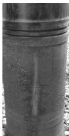
Фото 1. Втулка рабочего цилиндра с вертикальной трещиной двигателя 6ЧН25/34
