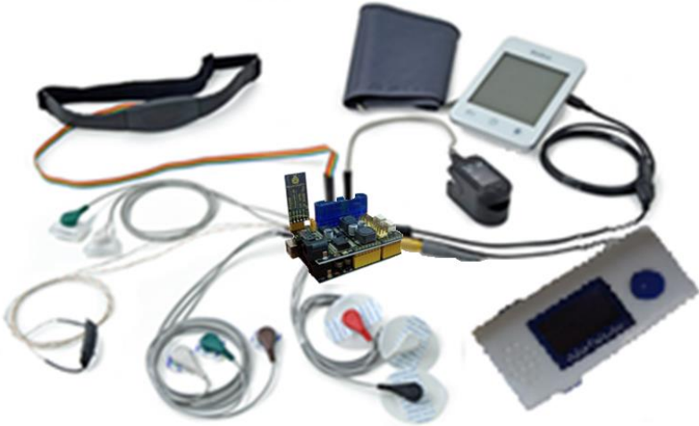
Рисунок 4 – Фото датчиків, що під'єднані до плати розширення медичних модулів, яка базується на Arduino
