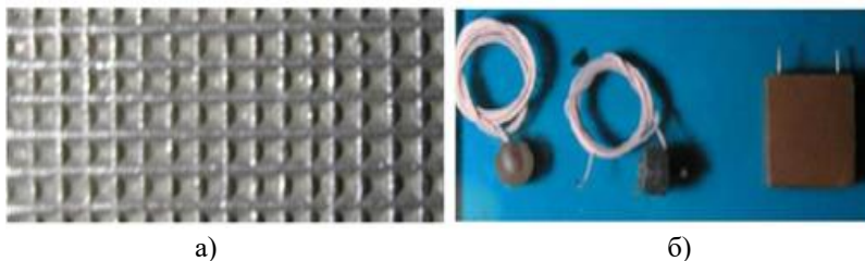
Рисунок 1 – Модуль контактної тиску: а) – чутливий елемент з м'якою поверхнею, б) – чутливі елементи датчика у зборі
