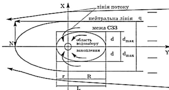
Рис. 1. Основні параметри розрахунку ЗСО (лініями на рисунку показано основні маршрути надходження води при водозаборі)
