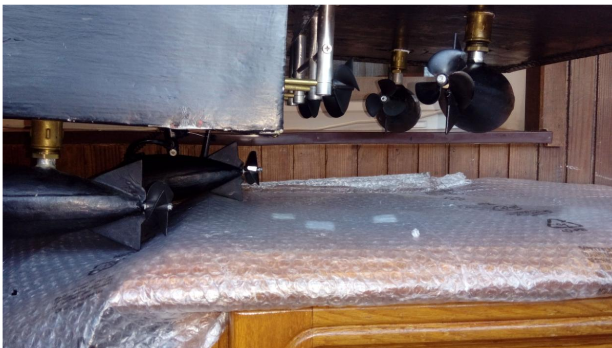
Рис. 4.11. Кормовой пропульсивный комплекс (вид сбоку)
