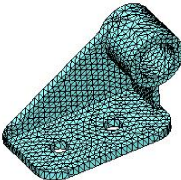
Рис. 2.1. Модель, поделенная на элементы методом конечных элементов
