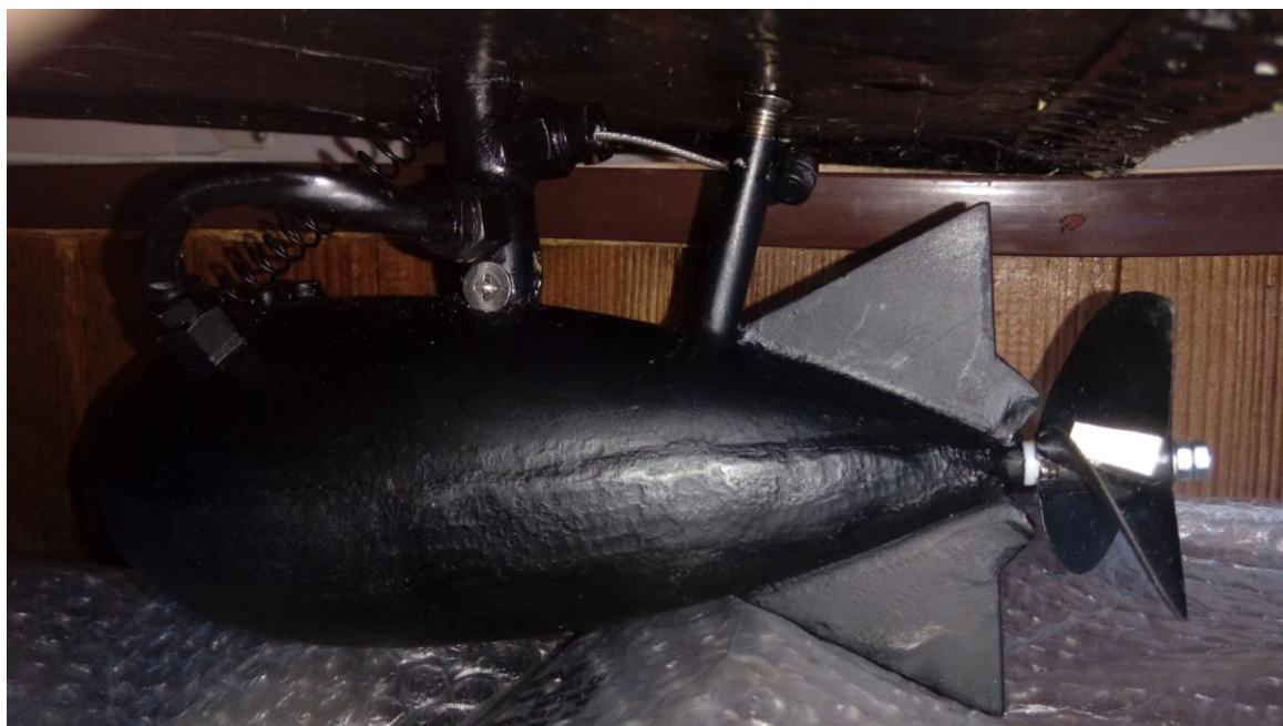
Рис. 4.12. Азимутальная винторулевая колонка с двумя степенями свободы
