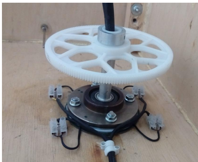
Рис. 4.15. Этапы монтажа пьезоэлементов на натурной модели: a) – монтаж ПЭ; б) – колонка в сборе
