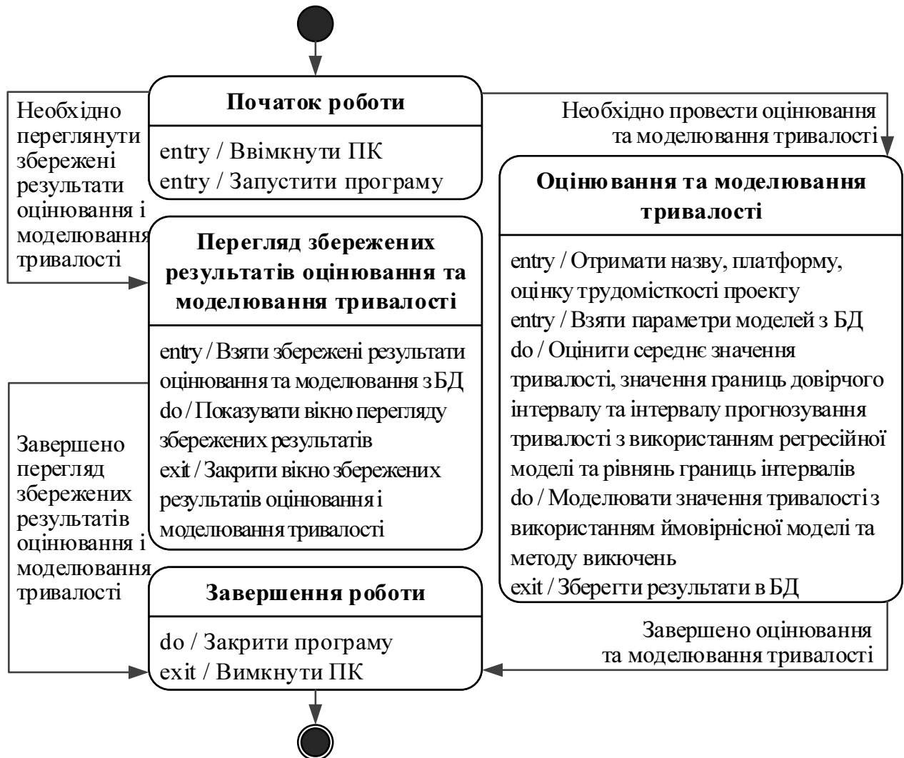
Рис. 4.7. Діаграма станів інформаційної технології переробки інформації для оцінювання тривалості проектів з розробки програмного забезпечення
