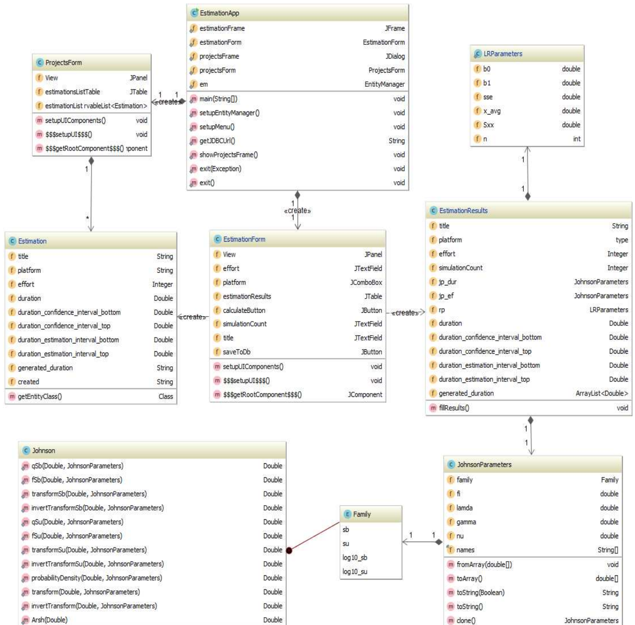
Рис. 4.3. Діаграма класів комп'ютерної програми з візуальним інтерфейсом «Оцінювання тривалості розробки програмного забезпечення»
