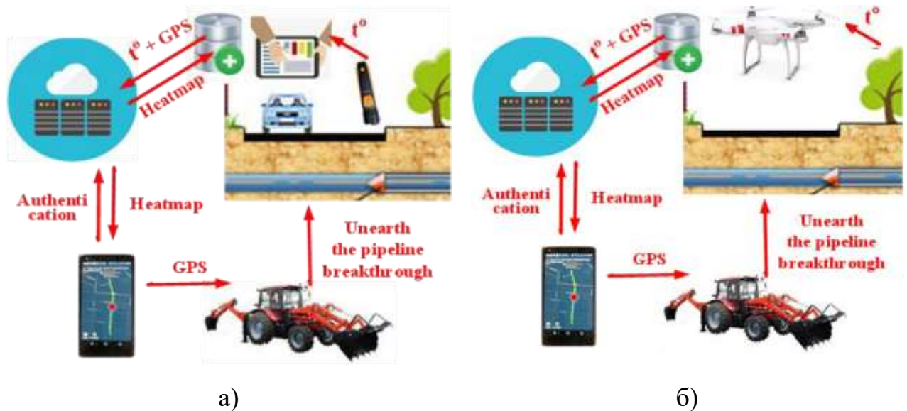
Рисунок 6.18 – Процедура пошуку прихованих місць витоку теплової енергії за допомогою об'єкта ШГКМ: а – з розміщенням тепловимірювача на автомобілі, б – з розміщенням тепловимірювача на БПЛА
