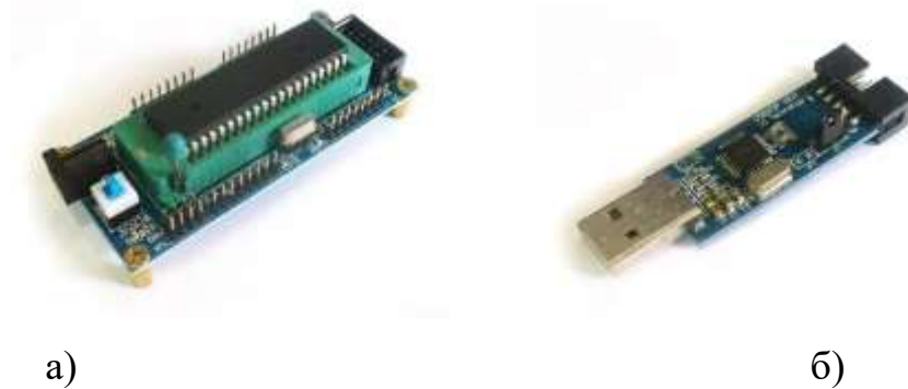
Рисунок А.4 – Контролер АТmega32 (а) з програматором USBasp v2.0 (б) для АТmega32
