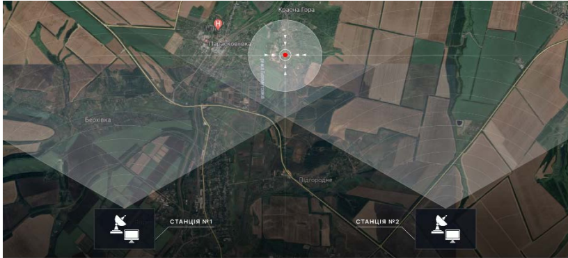
Рис.1. – Метод радіопеленгування засобів наземної РЕБ за допомогою двох пристроїв
