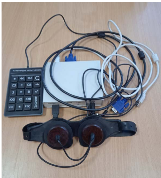
Рис. 1. Прилад для психофізіологічних досліджень «ПФИ-2»
