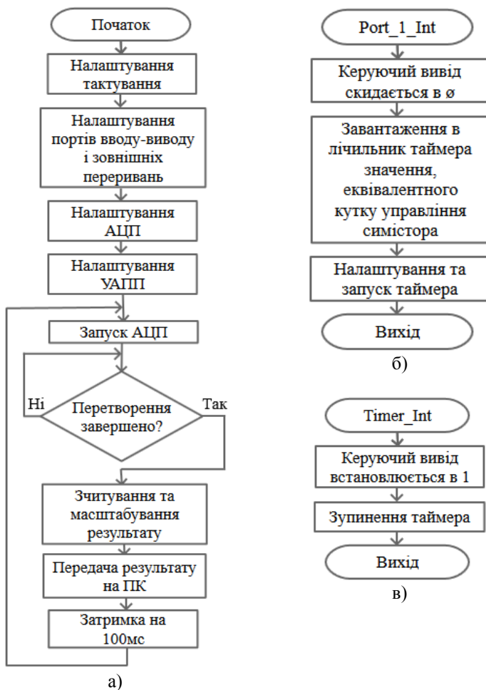
Рис. 1. Керуючий алгоритм для мікропроцесорного керування гарячим нагрівачем
