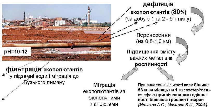
Рис. 15. Шляхи потрапляння в довкілля екополютантів хвостосховища № 1 червоних шламів Миколаївського глиноземного заводу
