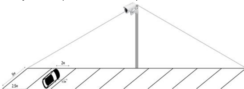
Рисунок 1 – Схема розумної парковки на основі камери зовнішнього спостереження
